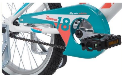
Рисунок 5 – Защита цепи А-типа
