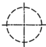
Рисунок 11 — Маркировка центра тяжести
