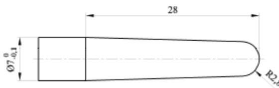
Рисунок 7 — Шаблон диаметром 7 мм для оценки сетки
